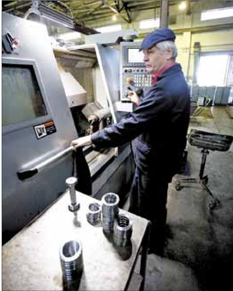
■ Современные станки с программным управлением повышают точность обработки деталей
