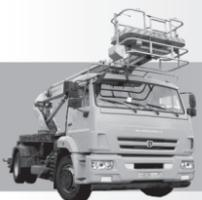
**Автогидроподъемник АПТ-18 (АПТ-22) на шасси КАМАЗ**
