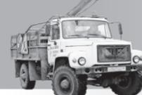
**БКМ-317 (бурильно-крановая машина) на базе ГАЗ-33081**
