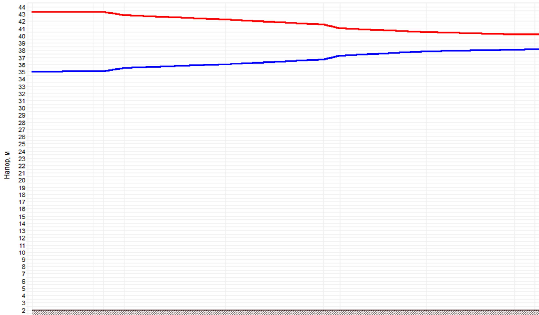
Рисунок 20.2 –График гидравлических режимов рассматриваемого теплопровода
