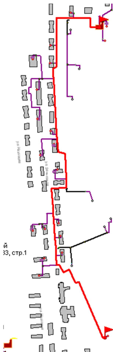
Рисунок 11.1 -Расчетный путь теплоносителя котельной до Пластмассового завода
