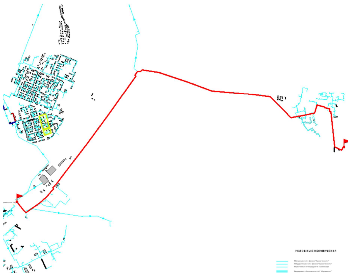
Рисунок 1.7 -Расчетный путь теплоносителя №4 от Архангельской ТЭЦ.
