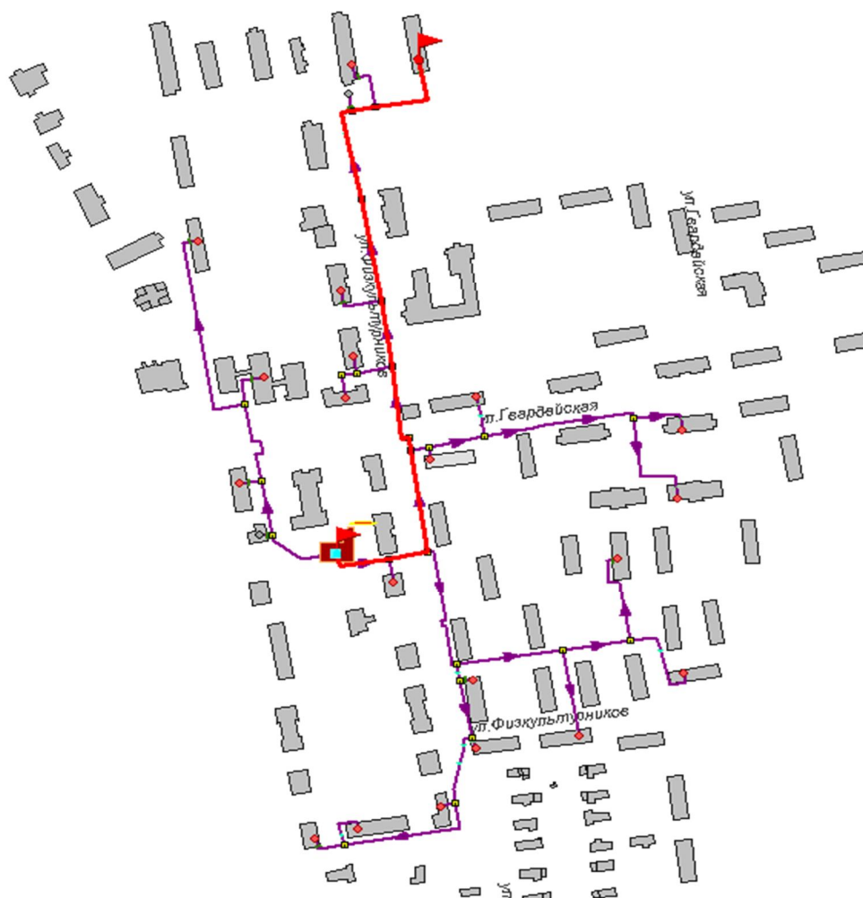
Рисунок 28.1 -Расчетный путь теплоносителя от котельной до Петрова,9
