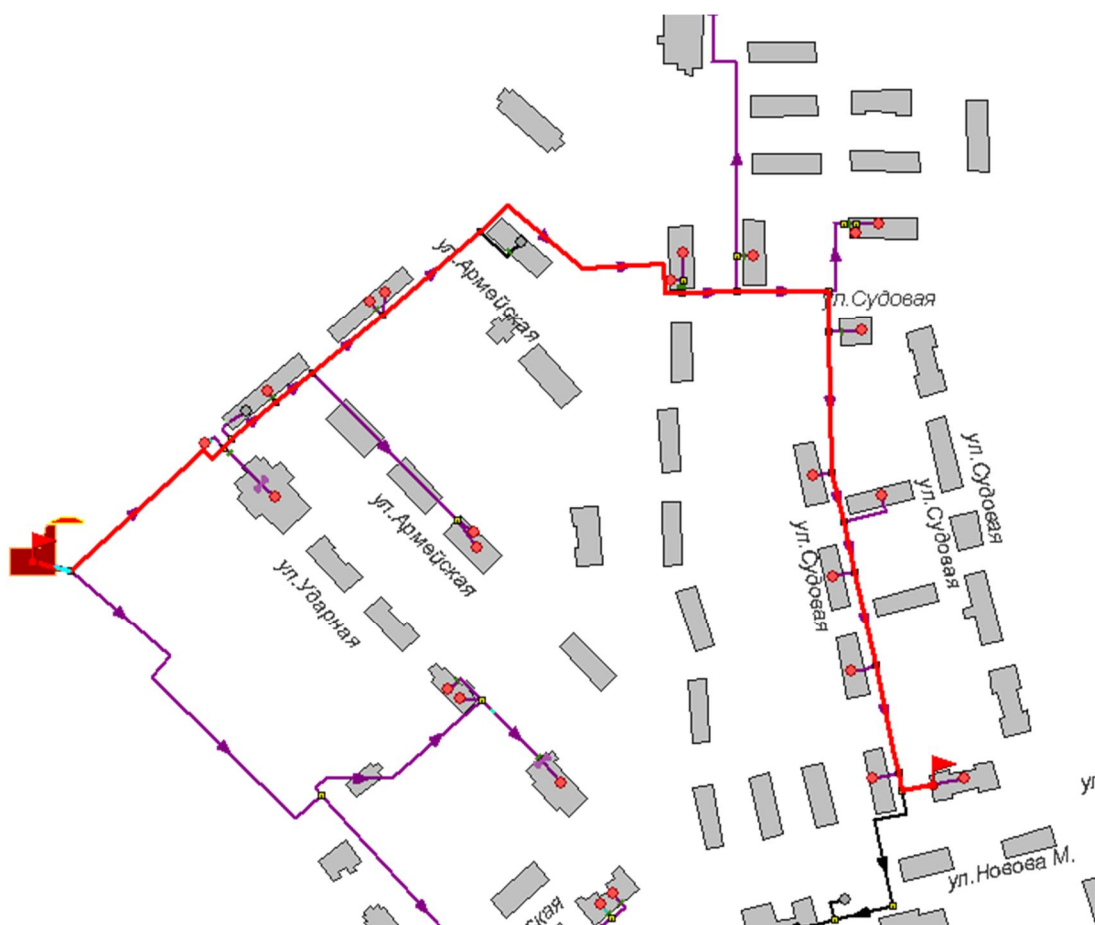
Рисунок 34.1 -Расчетный путь теплоносителя от котельной до Новова,17
