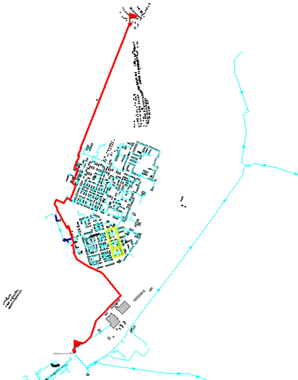
Рисунок 1.1 -Расчетный путь теплоносителя №1 от Архангельской ТЭЦ.
