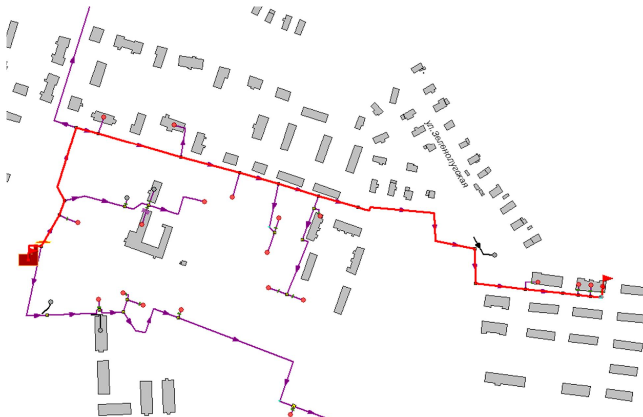
Рисунок 3.1 -Расчетный путь теплоносителя котельной до КЛДК 23, УУ1
