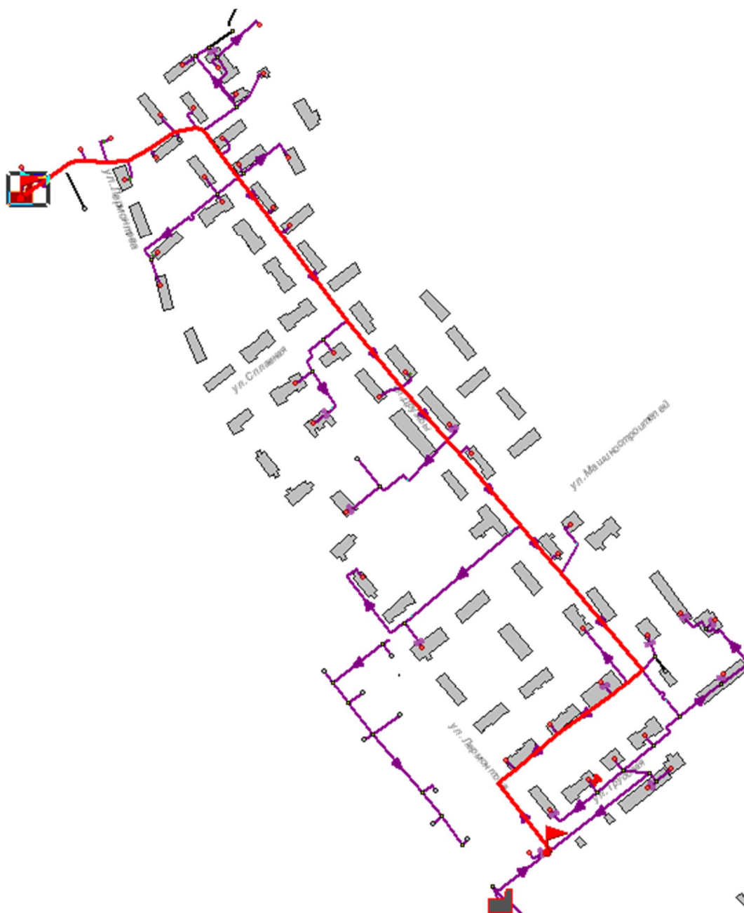
Рисунок 13.1 -Расчетный путь теплоносителя котельной до Лермонтова 23, стр.20
