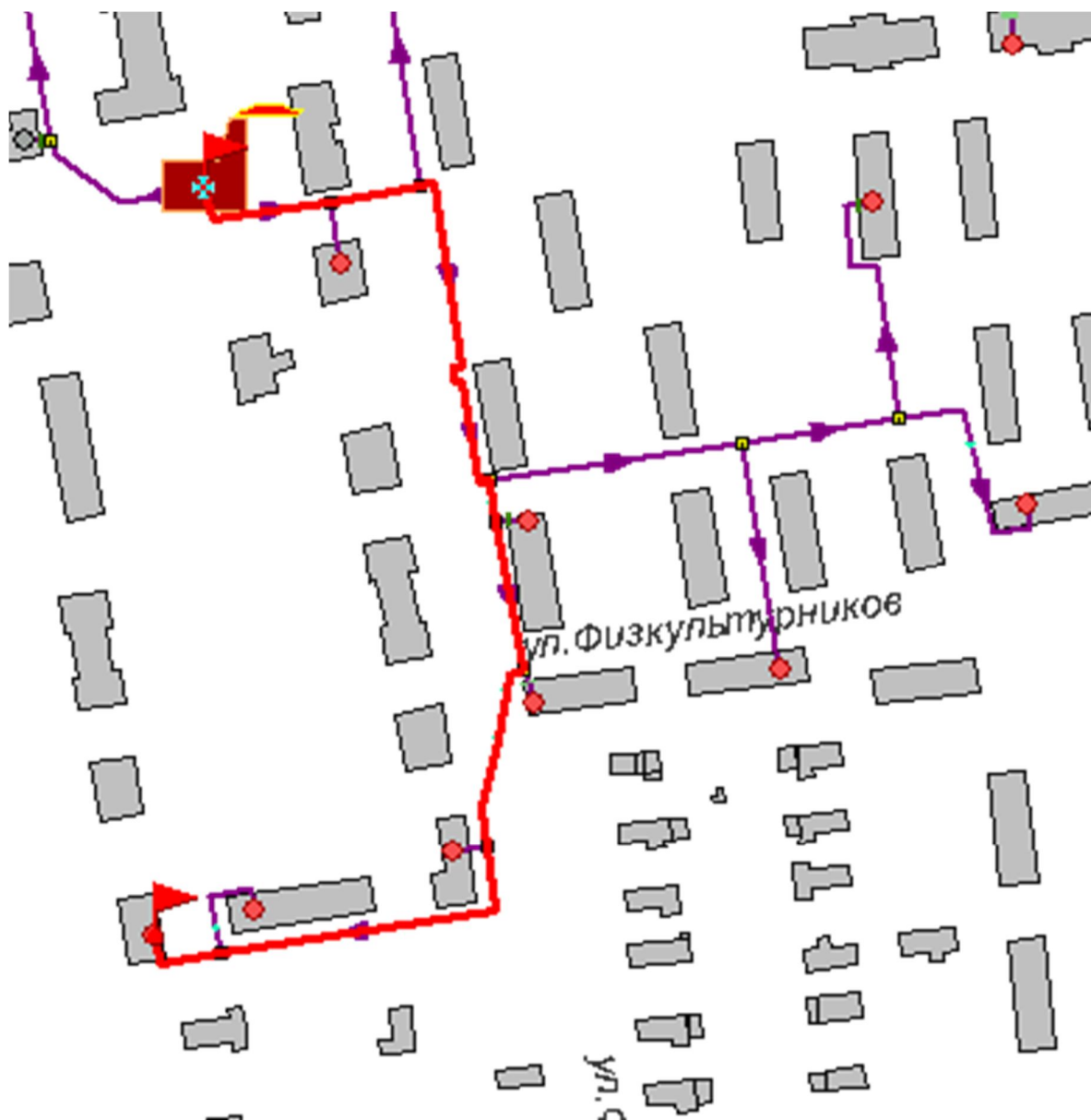
Рисунок 28.3 -Расчетный путь теплоносителя от котельной до Маслова,23 к.1
