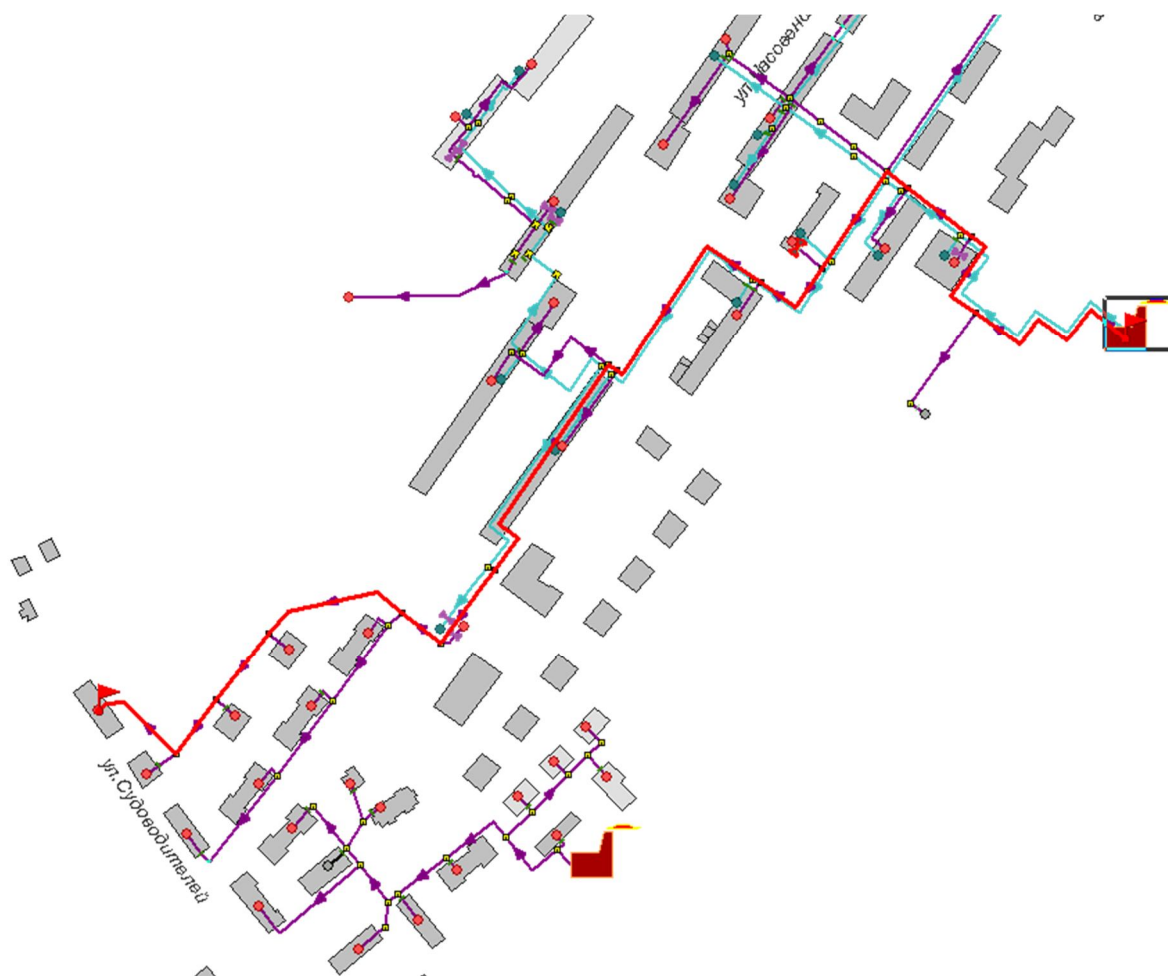
Рисунок 15.1 -Расчетный путь теплоносителя от котельной до Сив. Дивизии, 1
