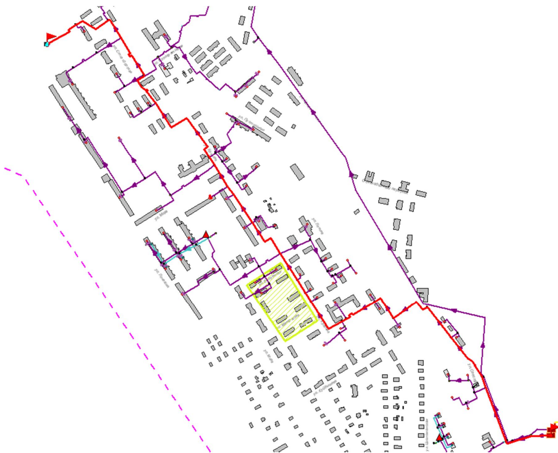
Рисунок 2.3 -Расчетный путь теплоносителя от Цигломенской ТЭС до Лочехина, д.13
