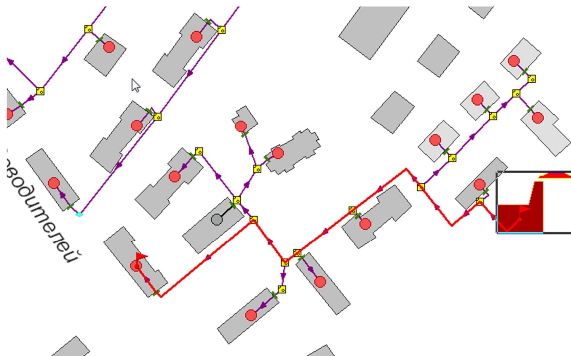
Рисунок 17.1 -Расчетный путь теплоносителя котельной до Речников,29
