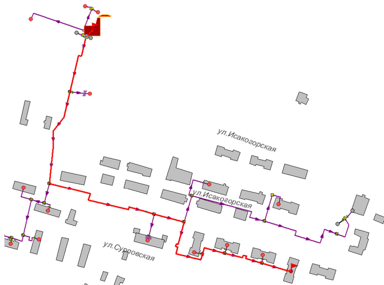
Рисунок 5.1 -Расчетный путь теплоносителя котельной до Сурповской, 20
