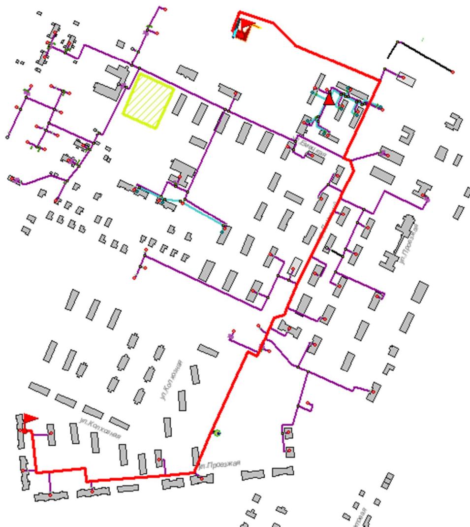
Рисунок 27.1 -Расчетный путь теплоносителя котельной до Колхозная,35
